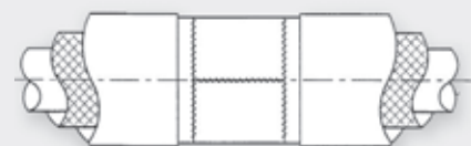
Passstück einsetzen und gasdicht verschweißen
